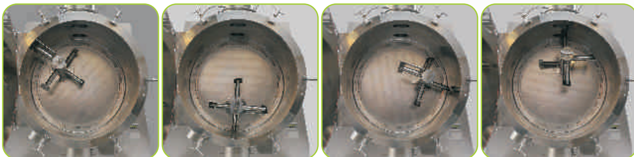
Эксцентрическая мешалка с двойным комбинированным вращением
